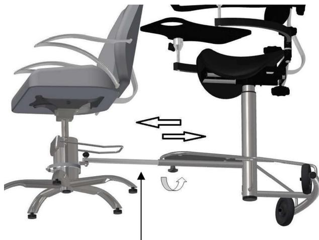
Siéntese y regule la distancia del **telescopico** que une la parte baja con la abrazadera hasta tenerlo a una distancia cómoda, para ello afloje el pomo que hay bajo el reposapiés que libera el telescopico.
